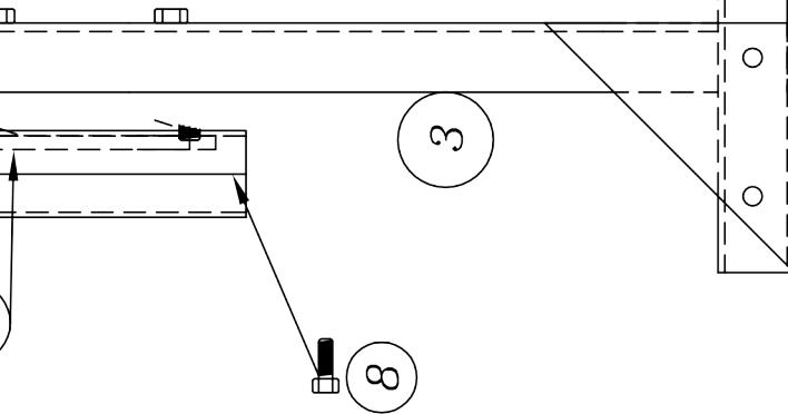
Die Box ist höhenverstellbar, indem Sie die 14 mm-Bolzen oben bzw. die 10 mm-Bolzen unten an der Boxkonsole lösen.
